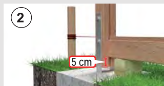
Unterste Profilveriehe mit 5 cm Abstand zum Pfostenende fixieren
