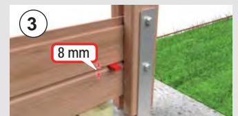
Auf Abstand von 8 mm zwischen den Profilveriehen achten, damit Holz „arbeiten“ kann
