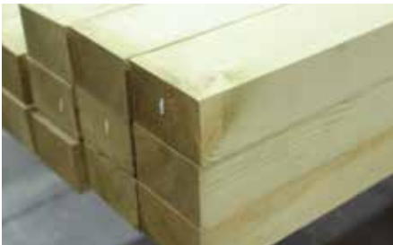
Imprägnierte Unterkonstruktion schützt das Holz gegen Feuchtigkeit und verlängert die Lebensdauer
